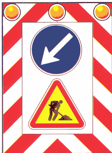
ET 12 — Atrilado de balizamento
