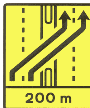
TD 12 — Desvio de faixa (2x3 vias) Desvio das vias esquerda e central para as vias esquerda e central da faixa contrária Dim. = 1,55 x 2,20 m
