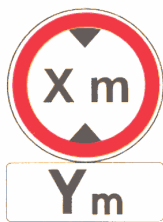
BT 3 — Trânsito proibido a veículos de altura superior a X metros a uma distância de Y metros
