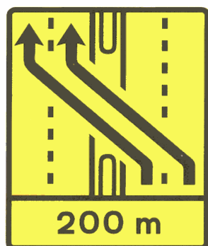
TD 11 — Desvio de faixa (2x3 vias) Desvio das vias esquerda e central para as vias esquerda e central da faixa contrária Dim. = 1,55 x 2,20 m
