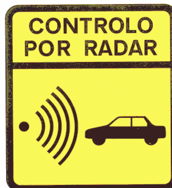
TV 6 — Zona de velocidade controlada Dim. = 1,50 x 1,50 m
