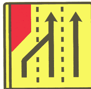
TD 4 — Painel de estrangulamento à esquerda (3 vias) — Desvio da via esquerda para a via central Dim. = 1,73 x 2,20 m
